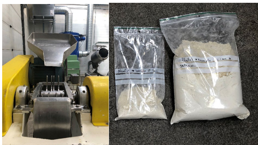
Figur 2 billeder af formaleren samt opnået formalet hestebønner.
