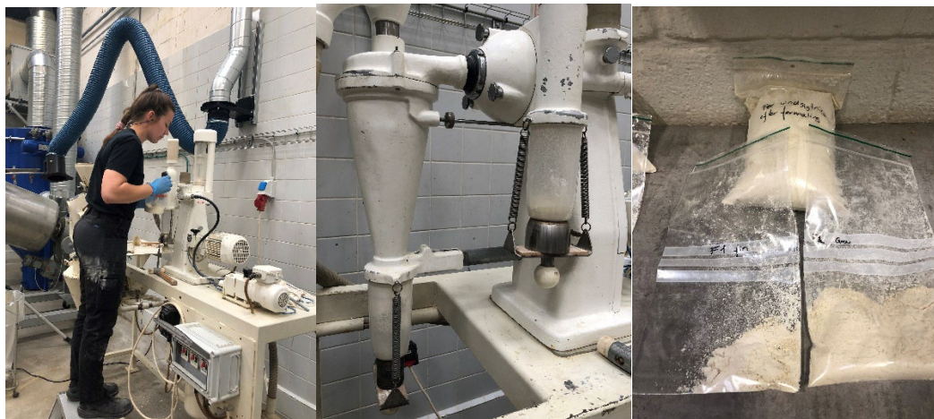
Figur 3 billeder af vindsigtningen og opnået fin og grov fraktion.
